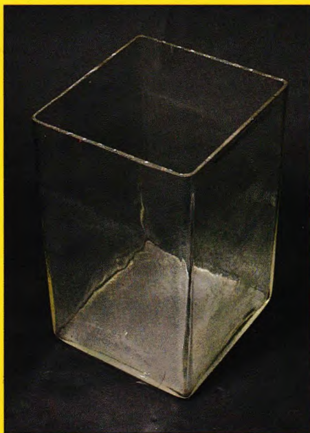
Afb. 1. Uitgangspunt is een glazen of kunststof bak. Op de foto een accubak van een vrachtwagen, maar een aquarium zal ook uitstekend voldoen. Verkrijgbaar bij de dierenwinkel en grote warenhuizen. De afmetingen zijn afhankelijk van de grootte van de te etsen printen.
